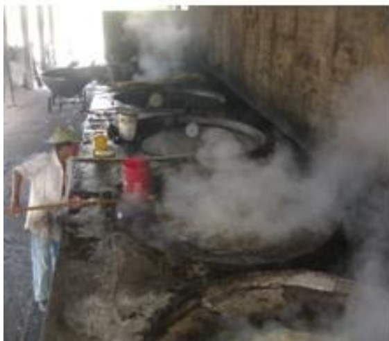
Gráfico 24: Evaporación en hornilla
