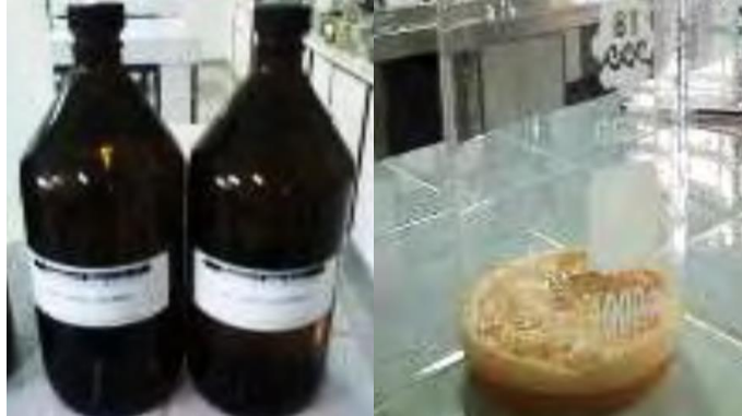
Figura 9: Desmineralización con ácido clorhídrico 1,3 N y agitación. Fuente: Barra, Romero & Beltramino (2012)
