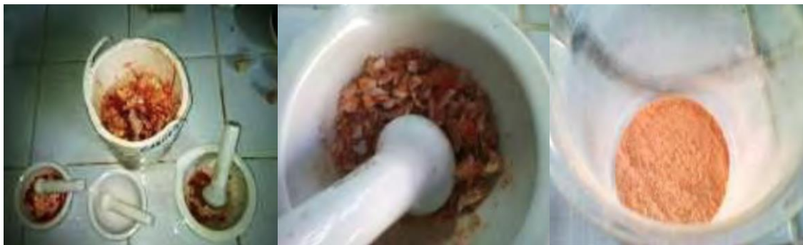
Figura 8: Trituración de la cáscara del camarón hasta ser polvo de granulometría fina. Fuente: Barra, Romero & Beltramino (2012)
