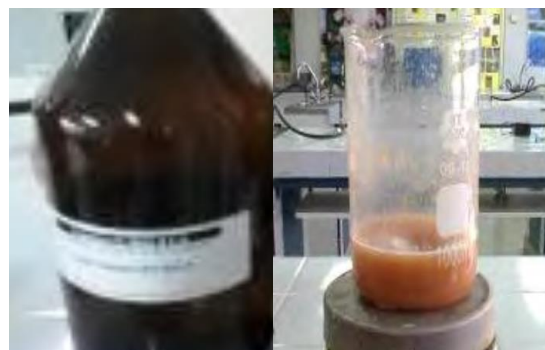
Figura 10: Desproteinización con hidróxido de sodio 0,8 N y agitación. Fuente: Barra, Romero & Beltramino (2012)
