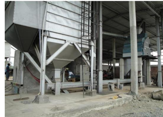
Sistema de secado a gas, torre vertical con pre limpia incluida.
