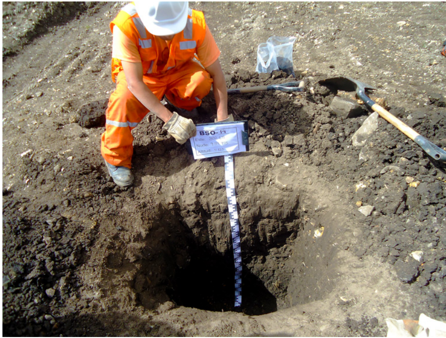
Figura 24.- Perforación para tomar muestra
