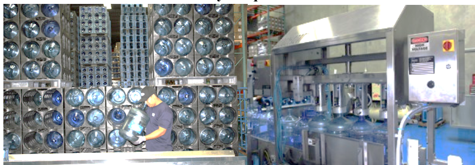
FIGURA No. 6 Almacenamiento y maquina de lavado de bidones
