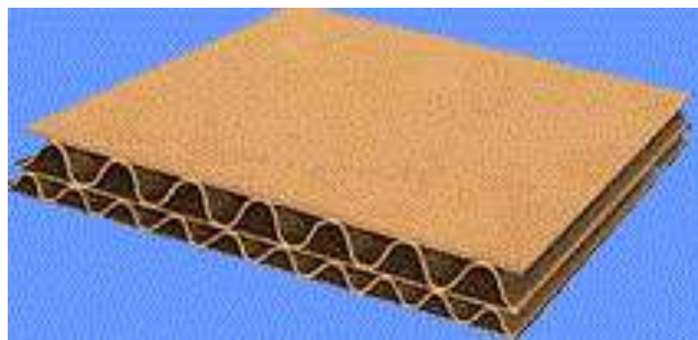
Figura 8 - Cartón Corrugado - Doble Pared
