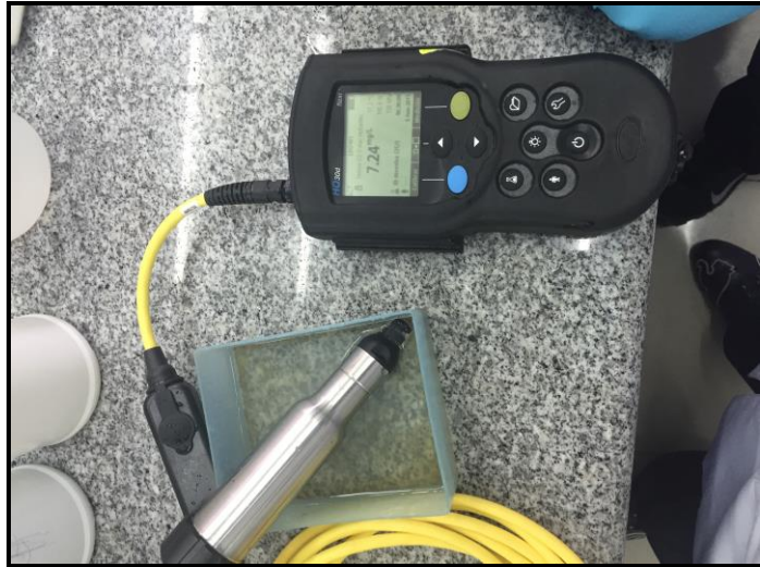
Fotografía 8: Equipo para medir oxígeno disuelto
