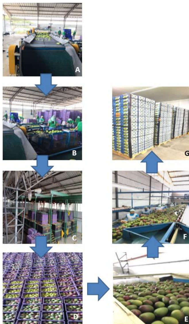
Figura 3. Procesos identificados en la empacadora. A) Recepción. B) Clasificación. C) Tratamiento Hidrotermico. D) Reposo. E) Encerado. F) Empaque. G) Enfriamiento.
