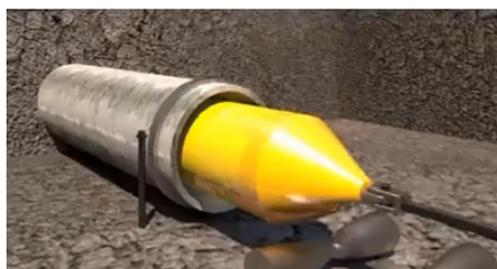
Figura 3.7. Recubrimiento interior de tuberías por halado
