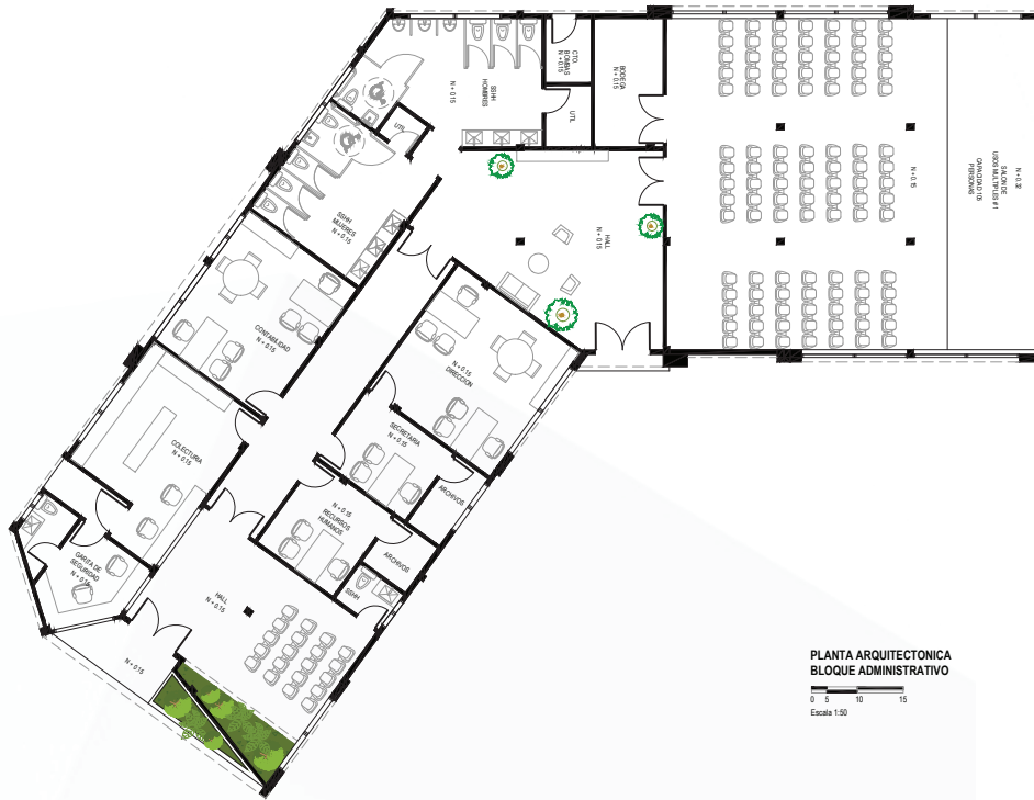
Ilustración 70: Planta arquitectónica - Bloque administrativo Fuente: Elaboración Propia.
