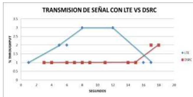
Figura 13.- Paquetes perdidos LTE vs DSRC "Escenario 1" Elaborado por. Autor
