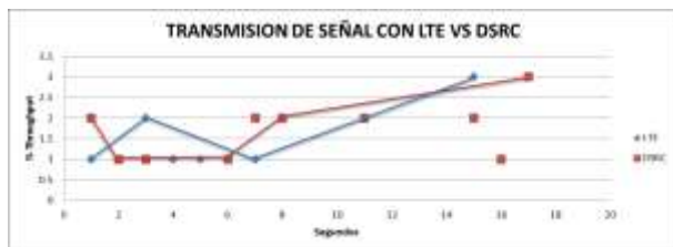
Figura 15.- Paquetes perdidos LTE vs DSRC “Escenario 3” Elaborado por. Autor
