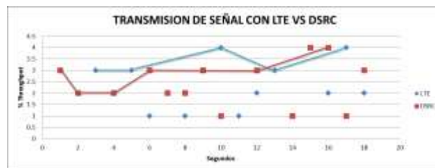
Figura 14.- Paquetes perdidos LTE vs DSRC "Escenario 2" Elaborado por. Autor
