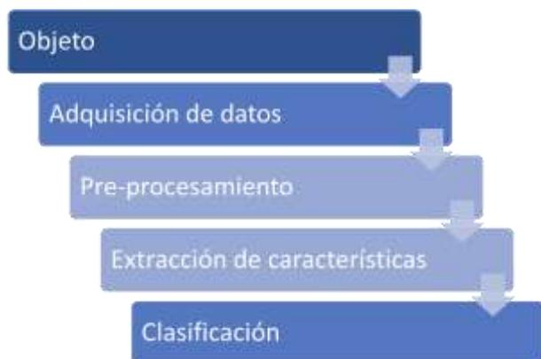
**Figura 3.** Estructura de un sistema de reconocimiento de patrones
