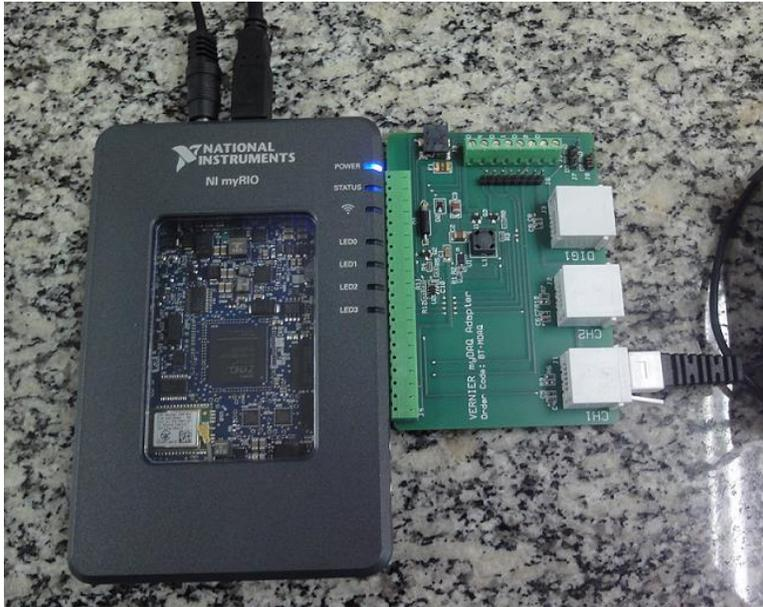
Figura A. 4 Conexión del dispositivo NIMyrio con el adaptador y el sensor de fuerza
