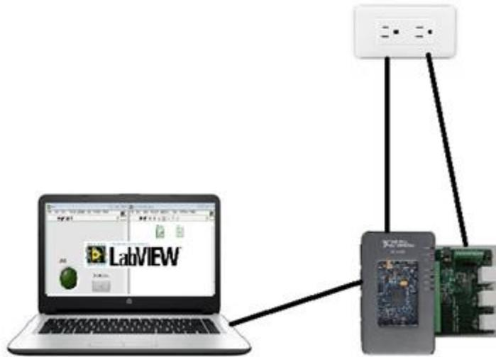
**Figura A. 60**Diagrama de conexiones del driver NI MyRio
