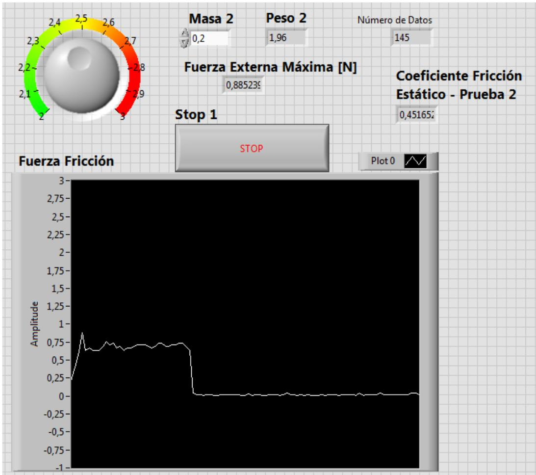
**Figura A. 12 Segunda prueba utilizando 0.20 Kg.**
