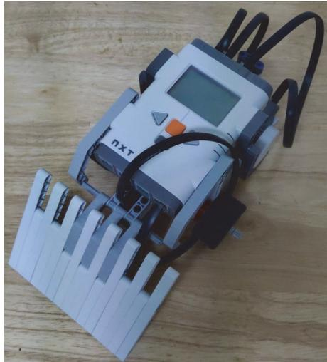
Figura 4.8 Robot sumo empleando el kit LEGO Mindstorms NXT
