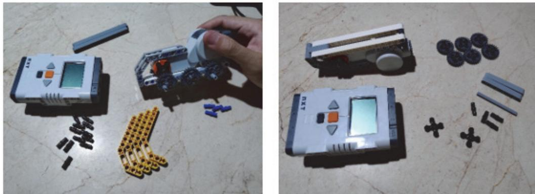
Figura 4.15 Armado del robot insecto empleando el kit LEGO Mindstorms XT
