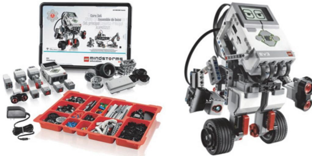
Figura 2.3 Plataforma LEGO Mindstorms
