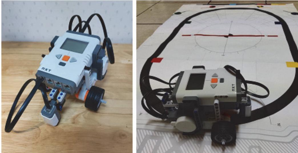
Figura 4.12 Robot seguidor de línea empleando el kit LEGO Mindstorms NXT
