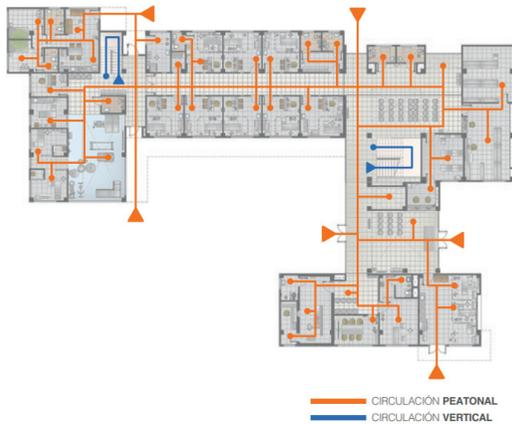
Imagen 26. Circulación y accesos de los centros de salud tipo B en Ecuador, planta baja. SECOB (2017)
