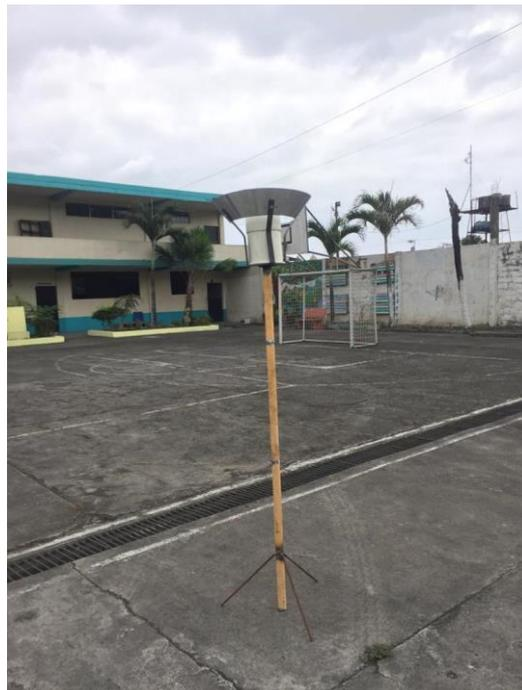
**Figura 5:** Colector de polvos ubicado en uno de los sitios de muestreo
