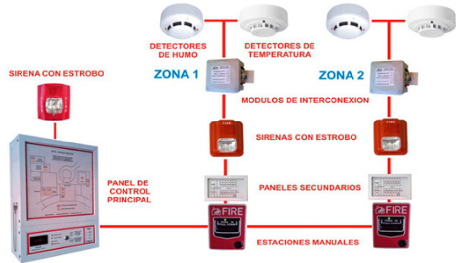
Imagen 11: Sistemas contraincendios (Fuente: Probac)
