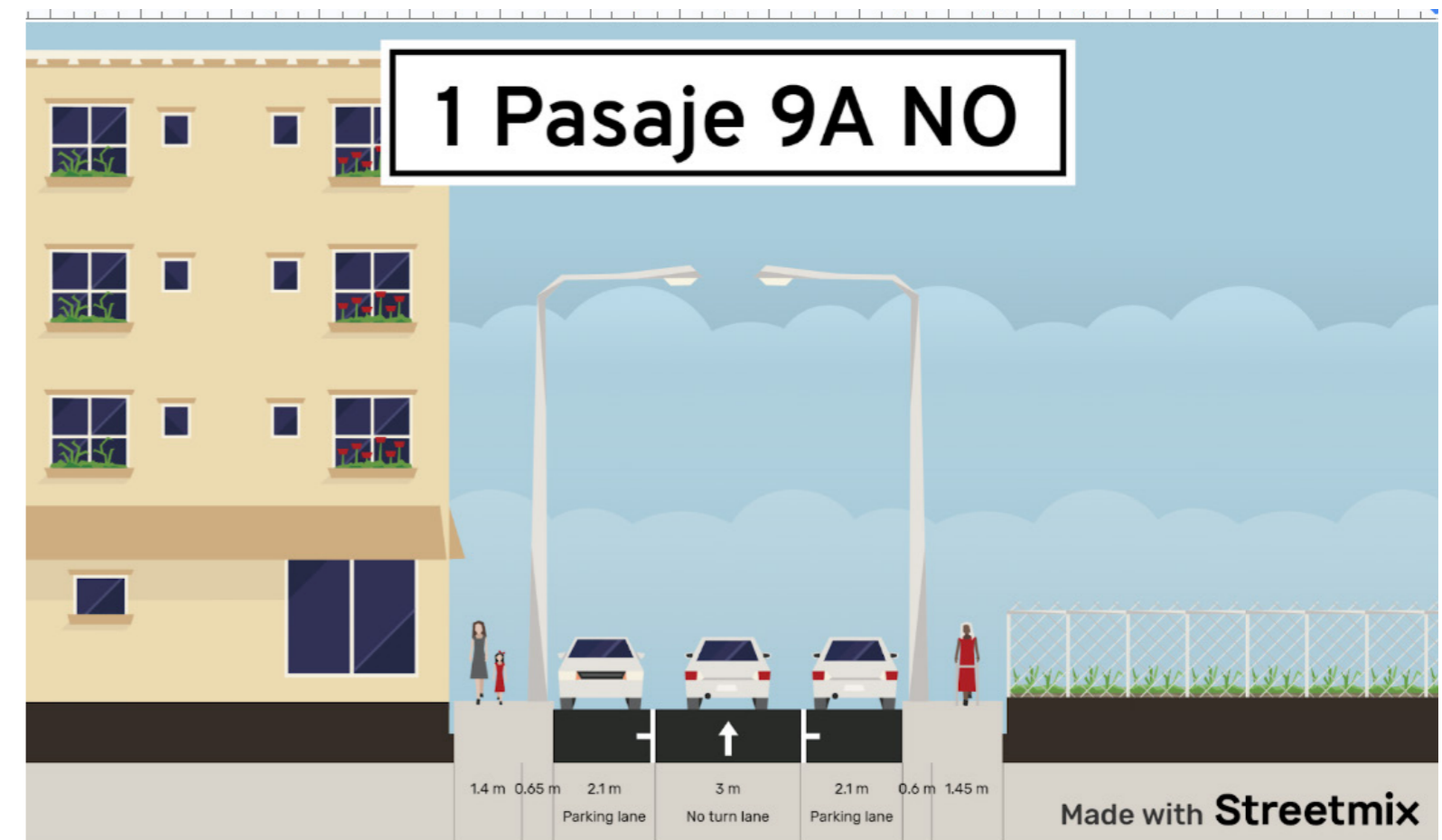
Figura 74 Sección Vía Terciaria 1 Pasaje 9A NO
