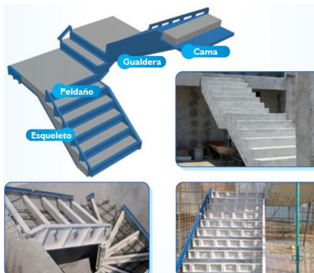
Ilustración 64. Armado de escalera
