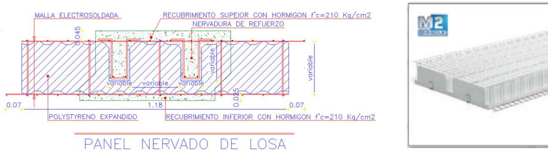
Ilustración 24. Panel nervado de losa
