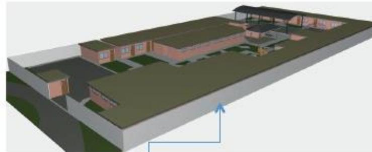
Cerramiento y distribución bloquea el flujo de aire en las zonas perimetrales, la incidencia solar sobre las superficies de hormigón de la cubierta intensifica el calor.
