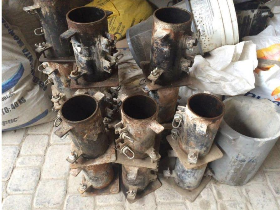
Ilustración 5: Encofrado metálico de cilindros
