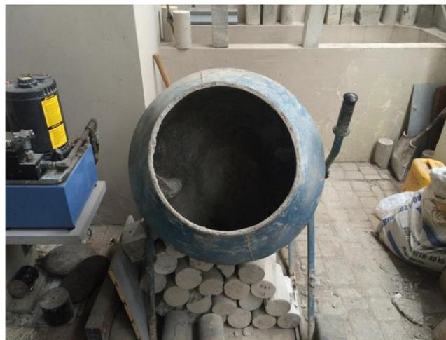
Ilustración 11: Concretera para realizar la mezcla de agregados
