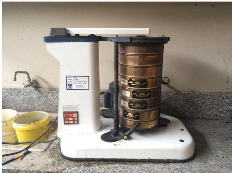
Ilustración 3: Máquina para tamizar
