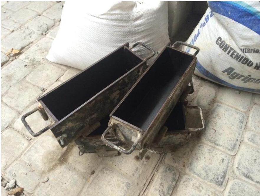
Ilustración 6: Encofrado metálico de viguetas
