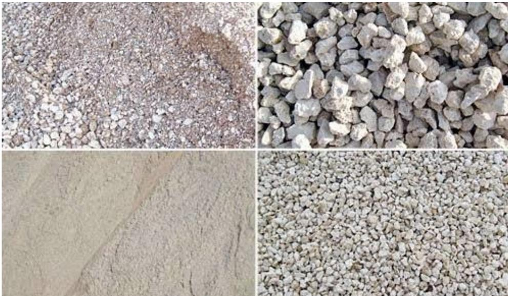
Ilustración 2: Agregados del hormigón
