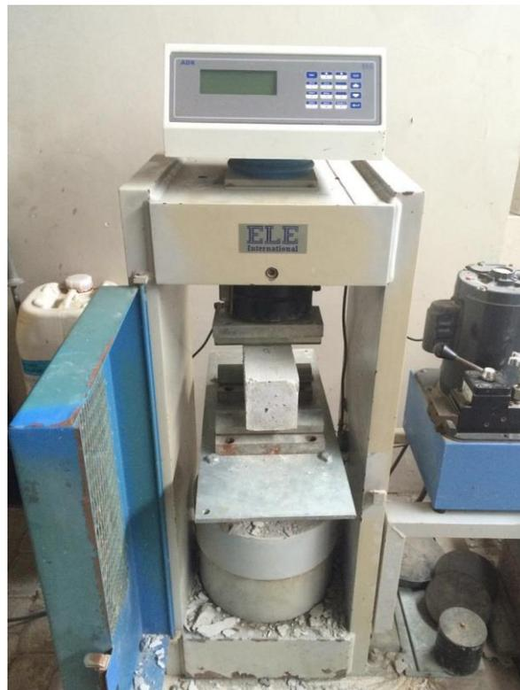
Ilustración 12: Prensa para ensayo de compresión y flexión de concreto
