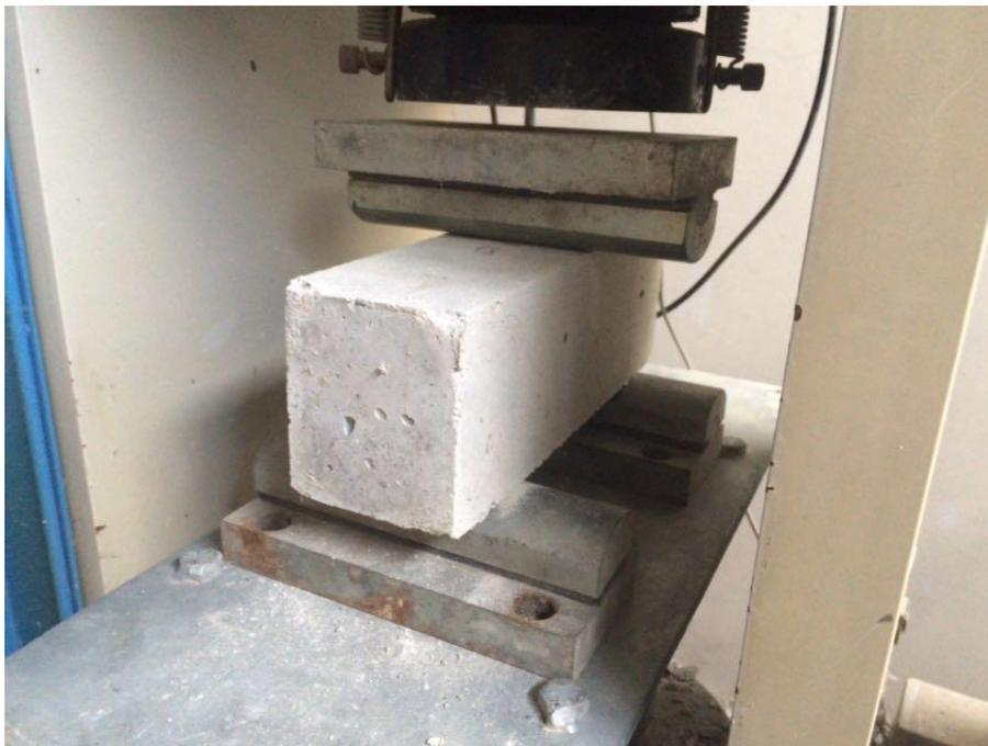
Ilustración 8: Viguetas en proceso de ruptura por flexión
