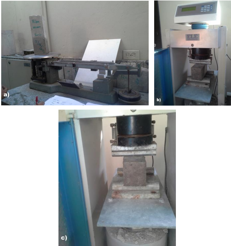
a) Muestras de las vigas rectangulares, b) Muestra sometida a ensayo a la flexión, c) Rotura de la viga rectangular.
