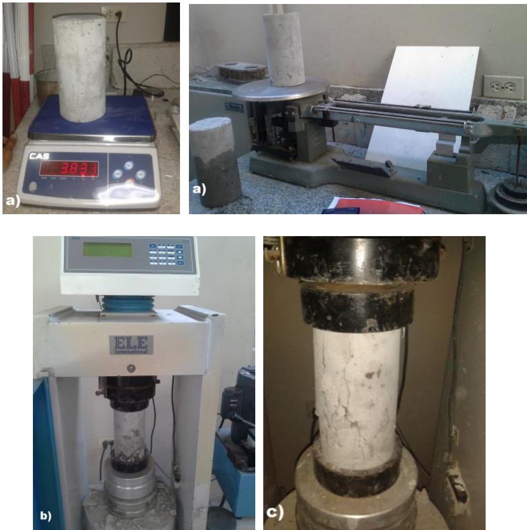
a) Peso de la muestra cilíndrica, b) Colocación de la muestra cilíndrica para previa rotura, c) Rotura de la muestra cilíndrica.
