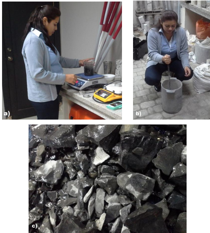
a) Peso volumétrico Suelto (PPV), b) Peso volumétrico Varillado (PVV), c) Absorción y Gravedad Específica.
