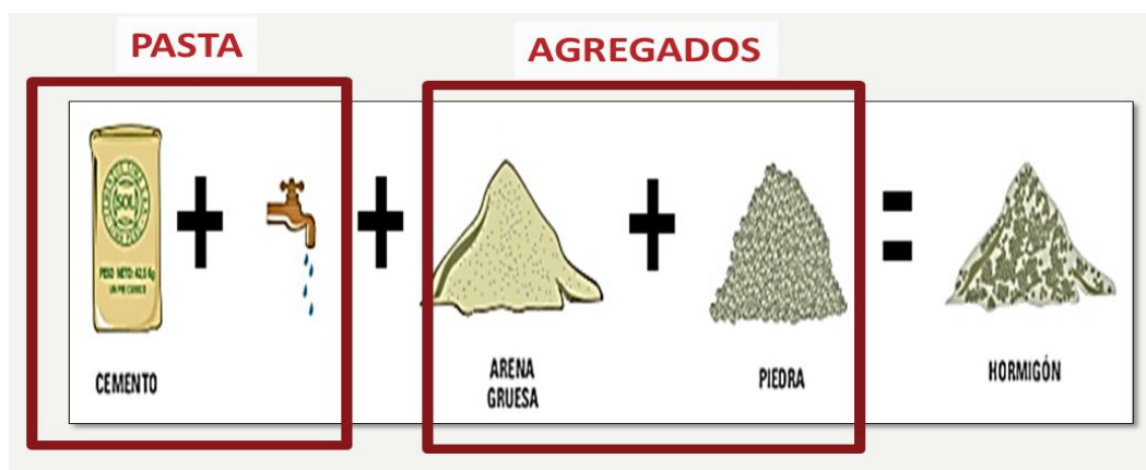
Figura 1 Elementos del hormigón.- cemento, agua, arena y piedra.
