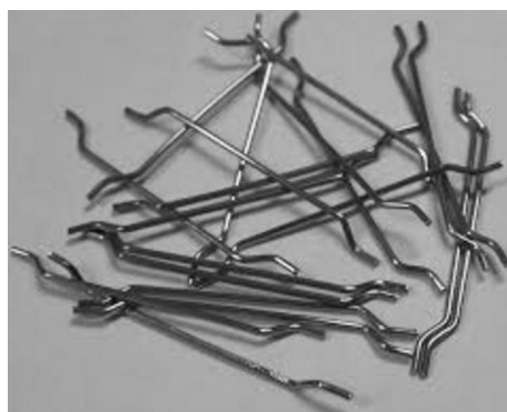
Figura 5 Fibra de Acero Drámix 3D
