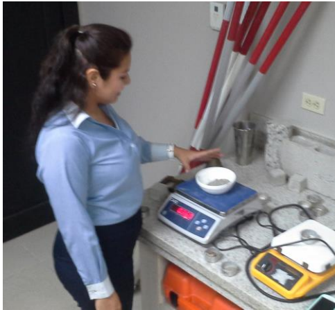
Peso volumétrico suelto (PVS),
