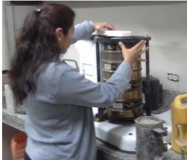
Figura 18 Ensayo para determinar la granulometría de los agregados según la norma ASTM C 33.
