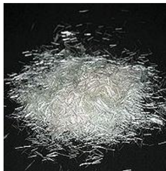
Figura 6 Hilos de Fibra de Vidrio.
