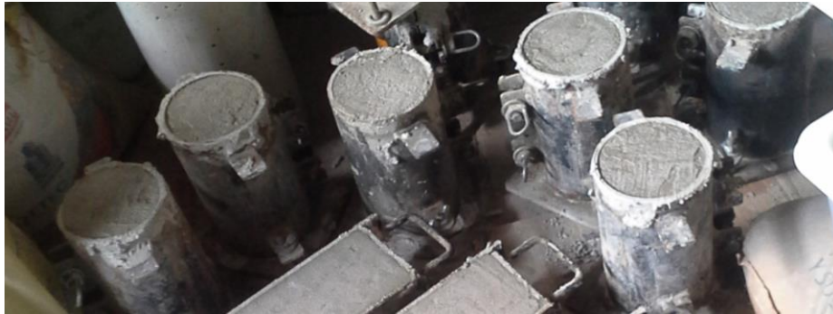
Figura 37 Elaboración de cilindros de hormigón tradicional con fibra de vidrio y de acero.
