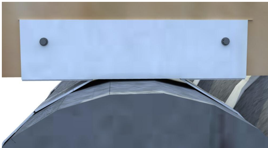
Imagen Nº 45-- Anclaje barriles - viga. Fuente: Elaboración propia.
