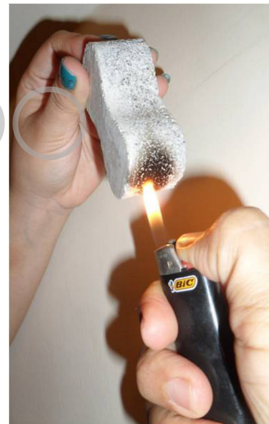
IMAGEN 136: Reacción del hormigón ante la presencia de fuego Fuente: Realizado por Denisse Aguilera
