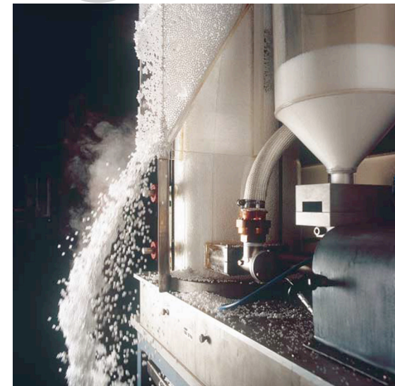
IMAGEN 115: Proceso de expansión de la materia prima Fuente: (BASF, 1998)
