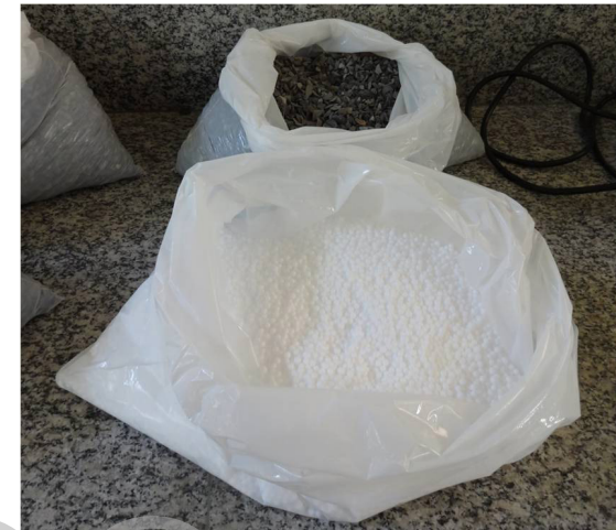
IMAGEN 114: Uso de micro perlita de poliestireno expandido como material de agregado grueso en hormigón Fuente: Fotografía tomada por Denisse Aguilera
