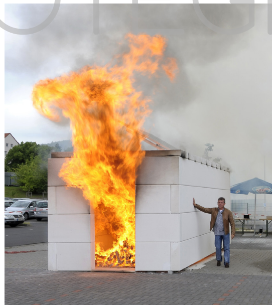
IMAGEN 97 : Resistencia al fuego de un panel de hormigón Fuente: (Xella International GmbH, 2013)
