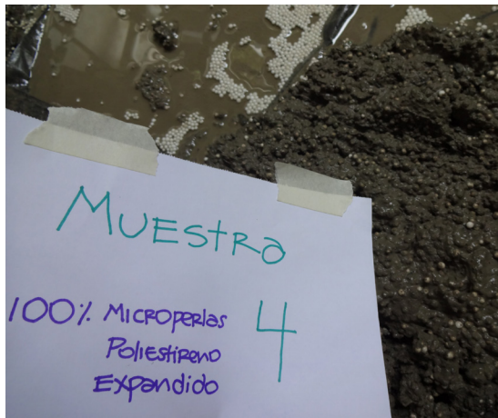
IMAGEN 198: Mezcla de hormigón MUESTRA 4 Fuente: Realizado por Denisse Aguilera
