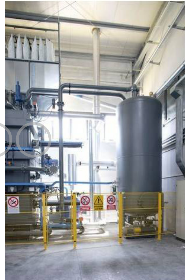
IMAGEN 143: Silo para proceso de vacío de poliestireno expandido Fuente: (Termodinámica, 2013)
