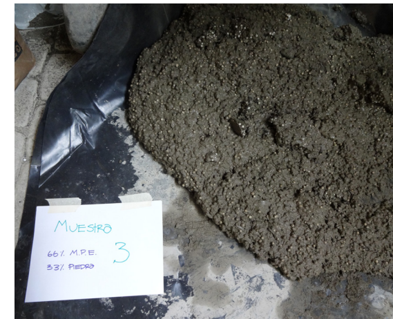
IMAGEN 196: Mezcla de hormigón MUESTRA 3 Fuente: Realizado por Denisse Aguilera
