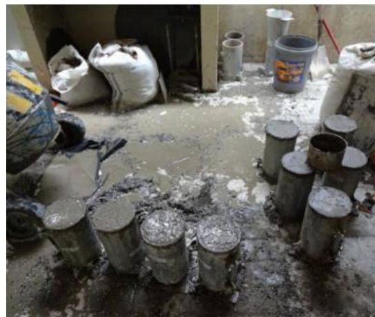
IMAGEN 200: Cilindros listos a fraguar Fuente: Realizado por Denisse Aguilera
