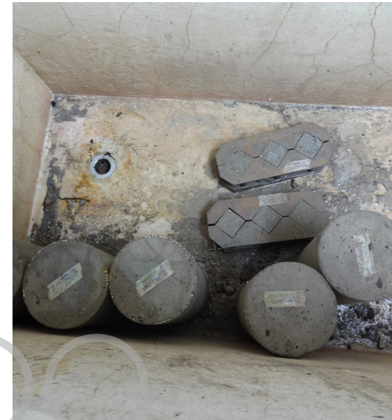
IMAGEN 201: Curado de los cilindros de hormigón Fuente: Realizado por Denisse Aguilera
