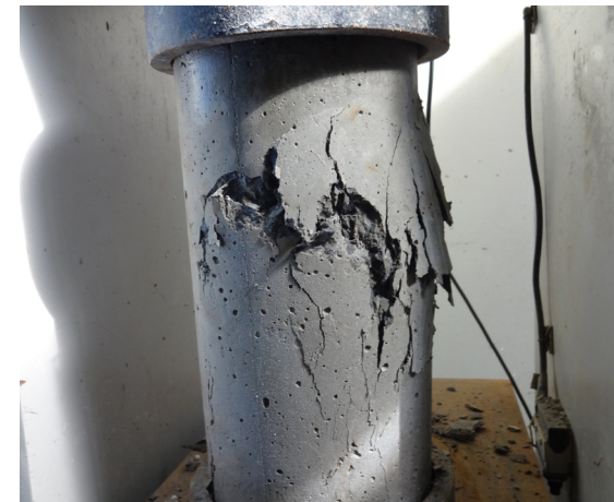
IMAGEN 202: Rotura de cilindro de hormigón Fuente: Realizado por Denisse Aguilera
