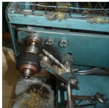
**FIGURA 12.** Vista del proceso de rizado del alambre.
