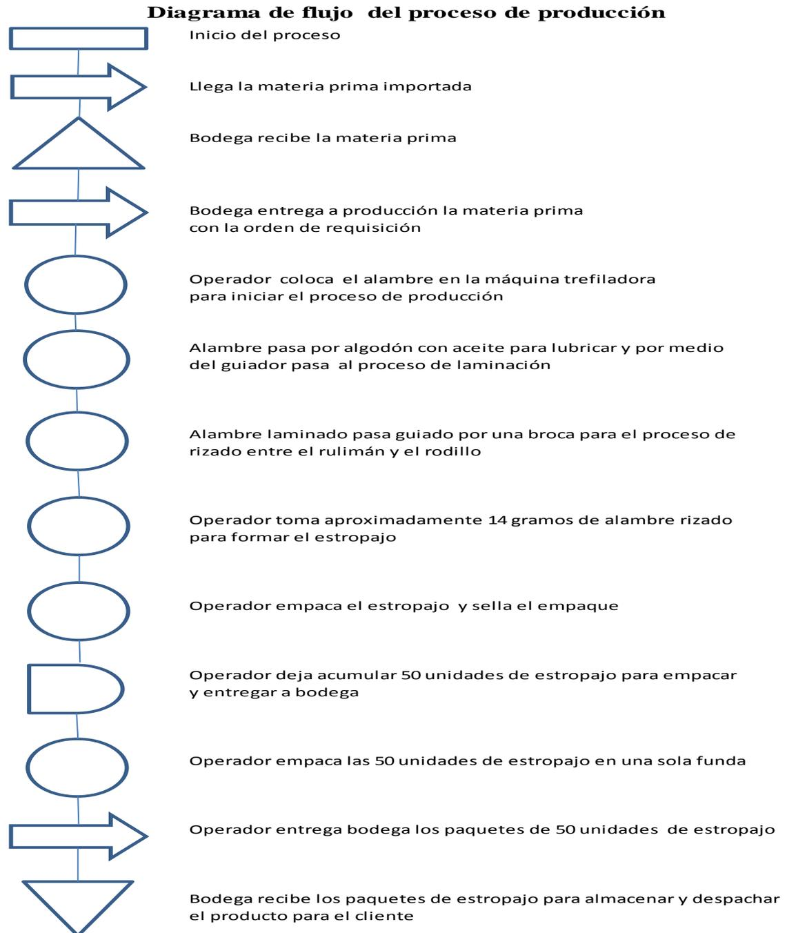
**FIGURA 16.** Diagrama de flujo del proceso de producción.
