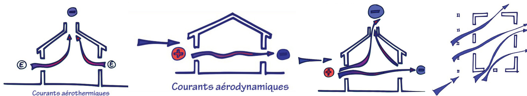
Figura No. 4.14. Esquemas de: 1) corrientes aerotérmicas; 2) corrientes aerodinámicas; 3) combinación de 1 y 2; y 4) ejes de flujo
