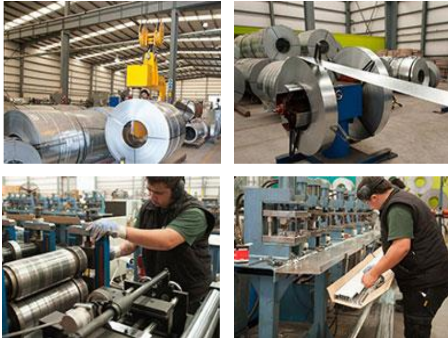
Foto 14. Proceso de fabricación de perfiles en acero galvanizado. Fuente: (JMA, 2015).
