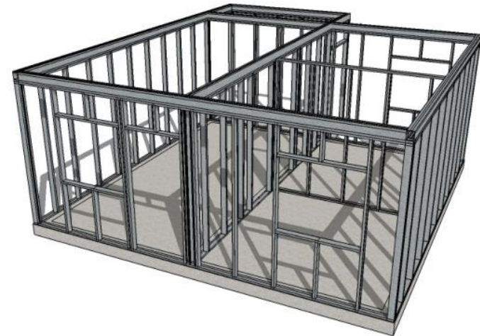
Figura 61. Fase 2: Elaboración, fijación e instalación de paneles estructurales. Fuente: Elaboración Propia.
