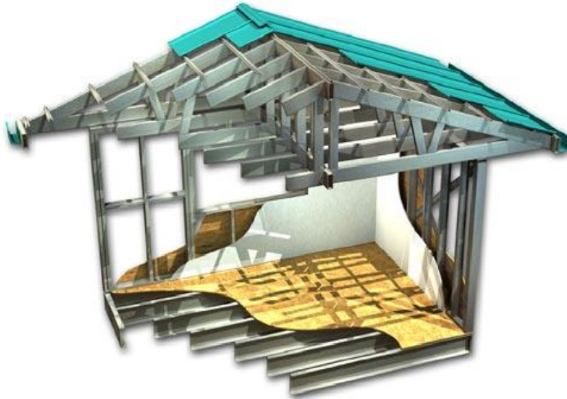
Figura 19. Esquema de Sistemas Constructivo Steel Framing. Fuente: (Soluciones Especiales, 2015).
