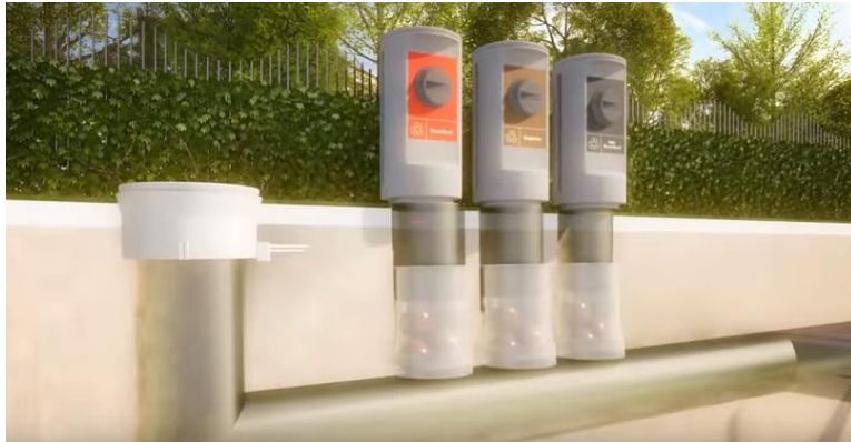
Ilustración 3. Conductos subterráneos para el traslado de basura hacia los centros de colecta
