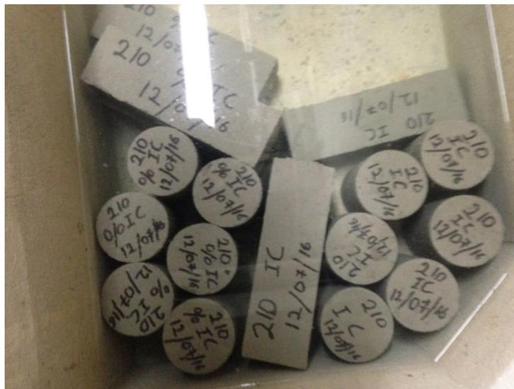
Ilustración 8: Cilindros y vigas
