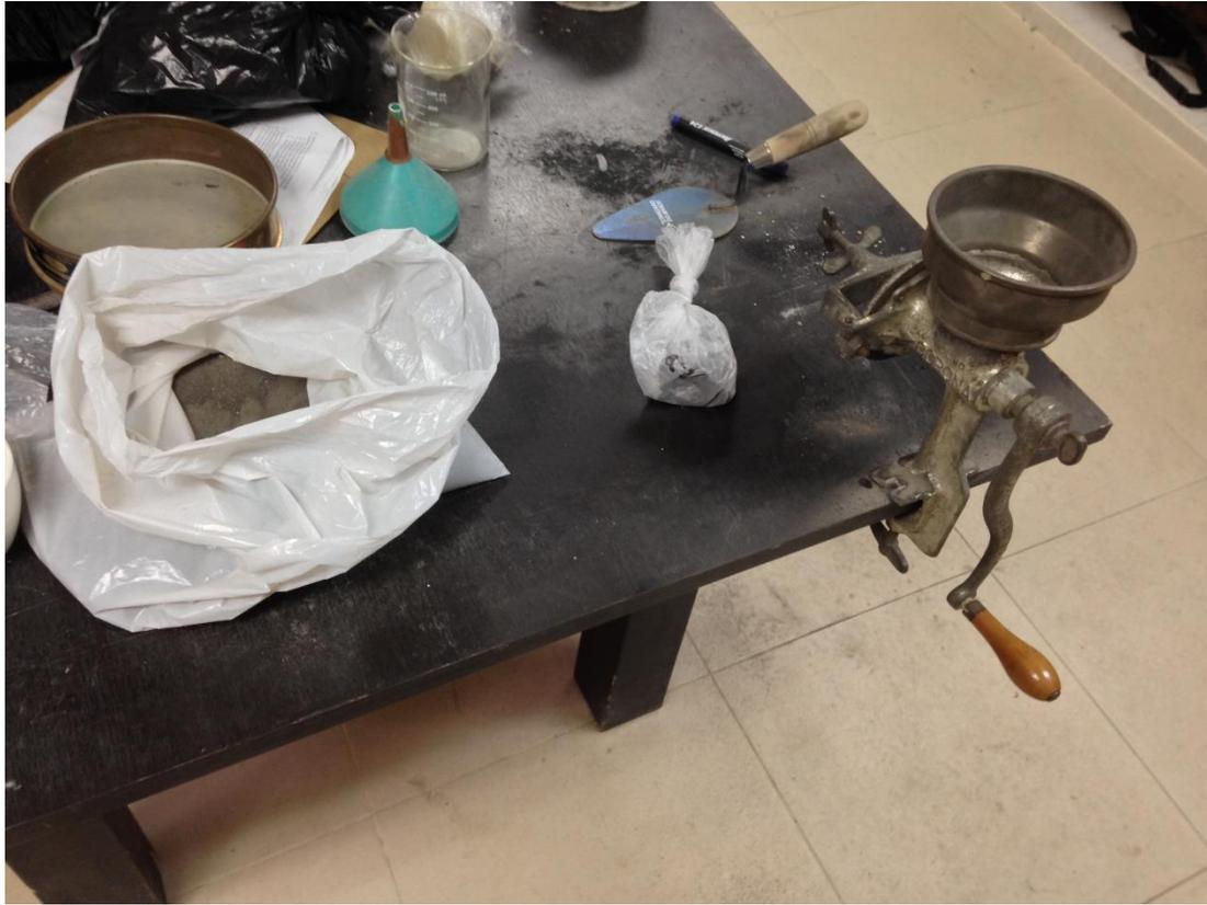
Ilustración 13: Molino para trituración de ceniza
