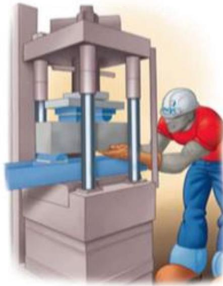
Ilustración 7: Ensayo de resistencia de la flexión del concreto
