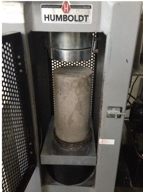
Ilustración 9: Ensayo a compresión de cilindro
