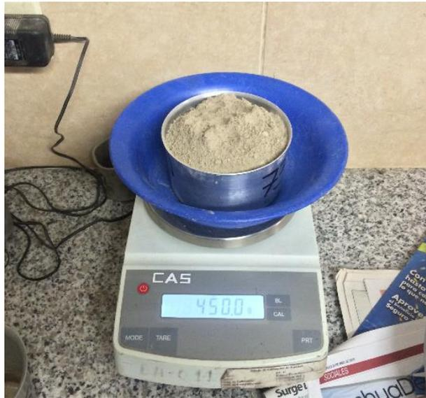
Ilustración 4: Peso de material para ser tamizado
