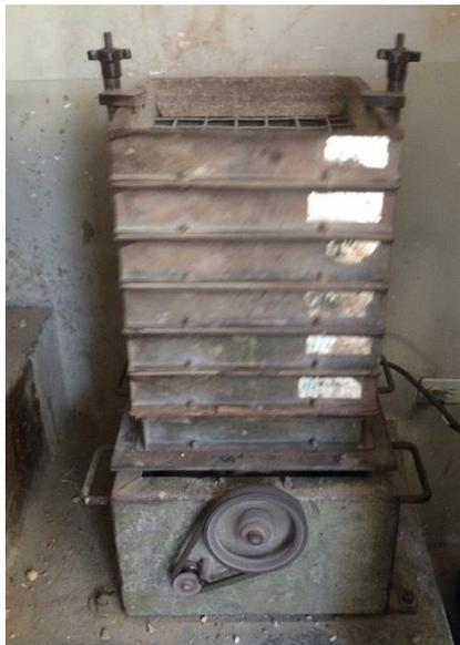
Ilustración 3: Máquinas de tamizado de los laboratorios UEES y A&E Guayaquil
