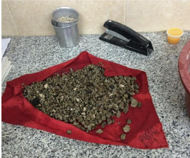
Ilustración 5: Tratamientos de Agregados para pruebas de absorción
