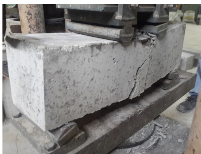
Figure 37 Modo de falla viga hormigón simple
