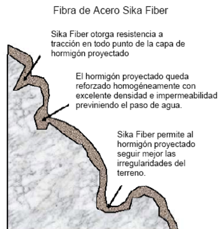
Figure 16 Shotcrete con malla Figure 17 Shotcrete con fibra de acero
