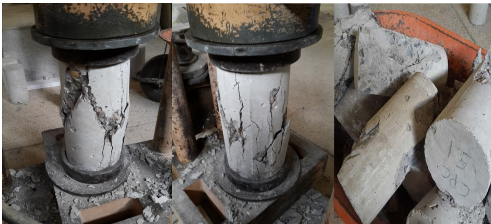
Figure 45 Modo de falla explosiva en cilindros de hormigón simple
