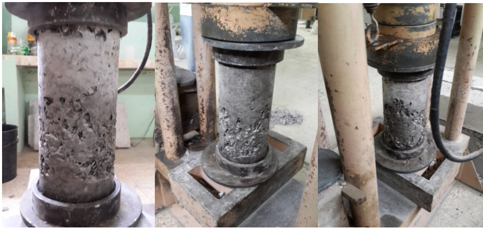
Figure 46 Espacios vacíos por la dificultad en la compactación
