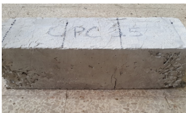
Figure 39 Modo de falla de viga con 1.5% de fibra de acero
