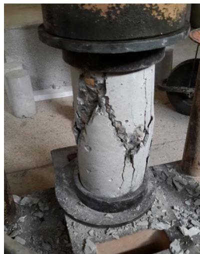
Figure 33 Modo de falla de cilindros a compresión
