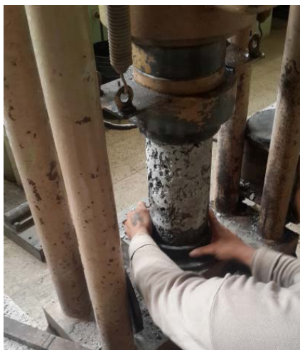
Figure 34 Cilindro con 1.5% de fibra de acero
