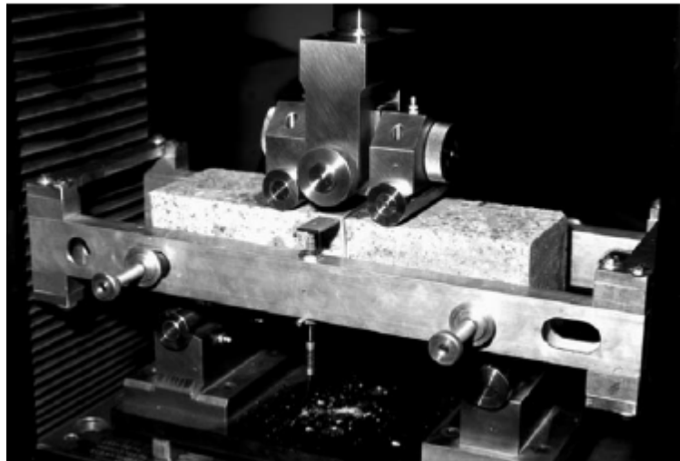
Figure 11 Ensayo ASTM 1609 para obtener valores relacionados a la deflexión
