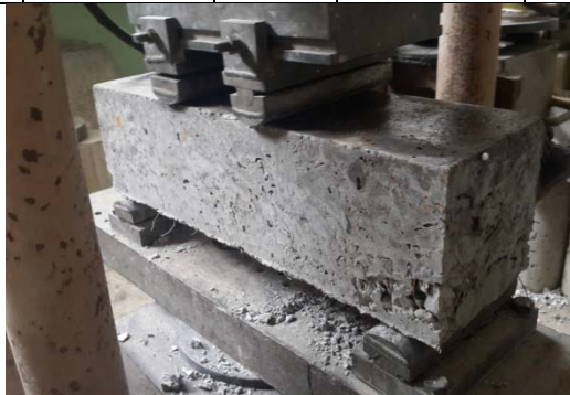
Figure 40 Ensayo vigas con 1.5% de fibra y 1 varilla de 10mm
