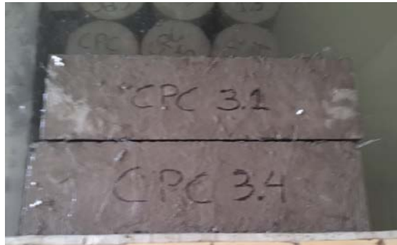
Figure 56 Curado de vigas en piscina
