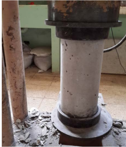
Figure 32 Ensayo de cilindros a compresión
