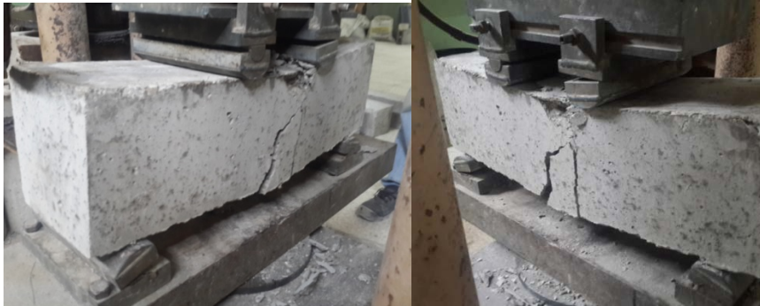
Figure 47 Modo de falla por flexión en vigas de hormigón simple
