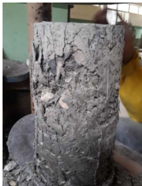
Figure 35 Modo de falla en cilindros con 1.5% de fibra de acero
