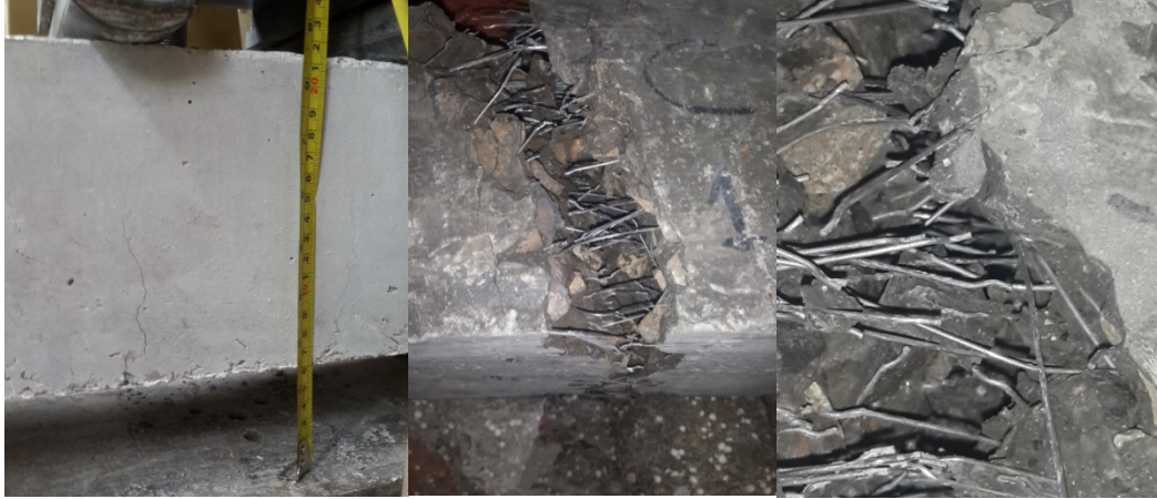
Figure 48 Micro fisuras y adherencia de la fibra de acero en la matriz de hormigón
