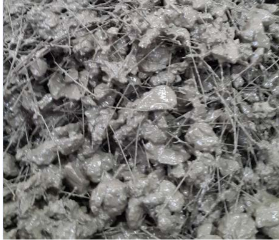
Figure 7 Incorporación de fibra de acero a la matriz de hormigón
