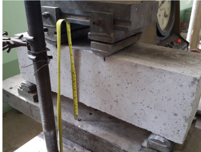
Figure 43 Ensayo a viga de hormigón simple con 2 varillas de 10mm
