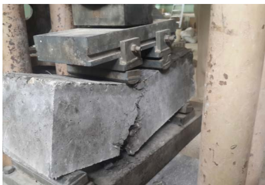
Figure 41 Modo de falla vigas de hormigón con 1.5% de fibra y 1 varilla de 10mm
