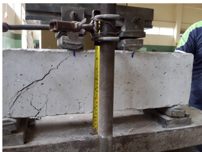
Figure 44 Modo de falla de viga de hormigón simple con 2 varillas de 10mm
