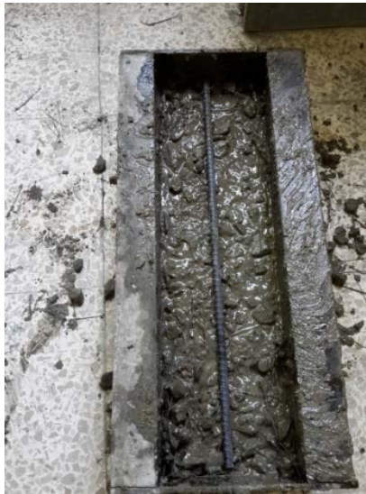
Figure 52 Posición de varilla en vigas
