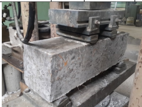
Figure 38 Ensayo de vigas de hormigón con 1.5% de fibra de acero
