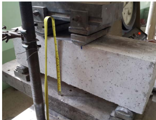
Promedio a flexión de vigas de hormigón con 1 varilla de 10mm
