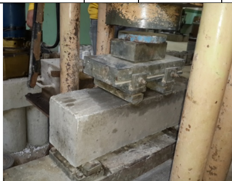
Figure 36 Ensayo a flexión en vigas de hormigón simple
