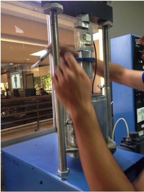
Fig.15. Colocación de Pistón CBR.
