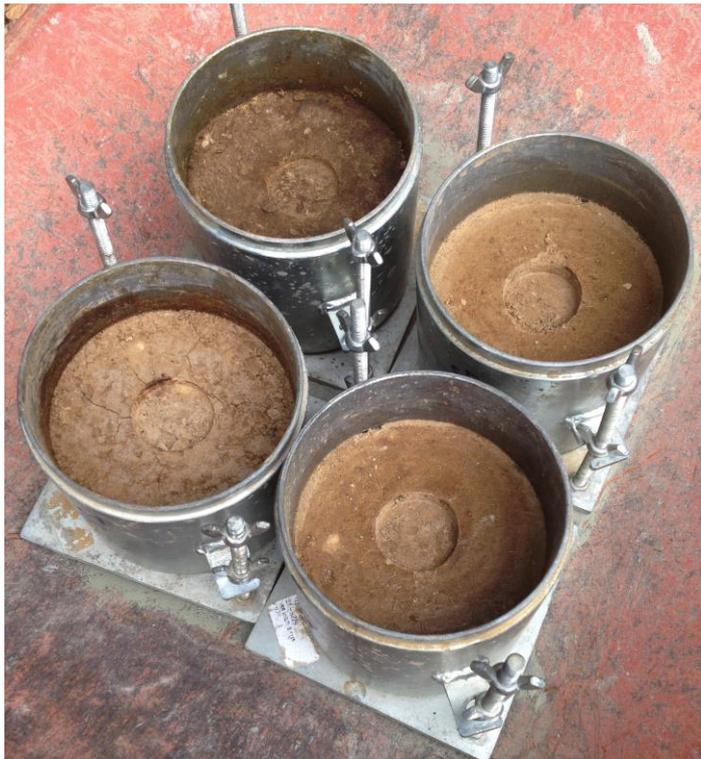
Fig.22. Muestras de Grava Arcillosas y Polímero ya Perforadas.
