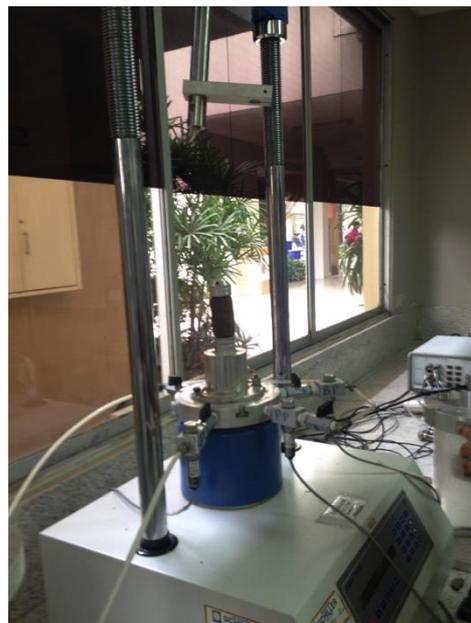
Fig.26 - 27. Máquina de Compresión Simple mas muestra de
