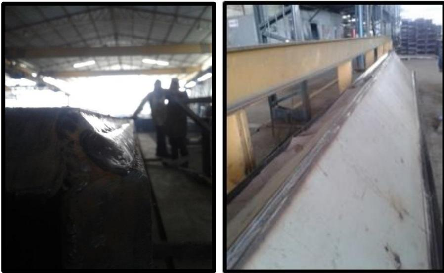
**Foto # 15:** Columna soldada con arco sumergido
