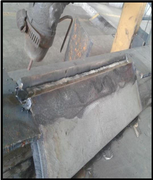
**Foto # 14:** Segunda pasada de soldadura con arco sumergido en una probeta de columna con placas de extremo
