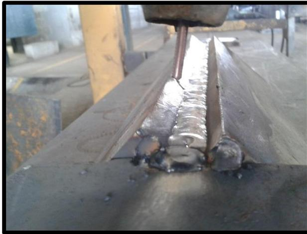
Foto # 17: Soldadura con arco sumergido en probeta de columna
