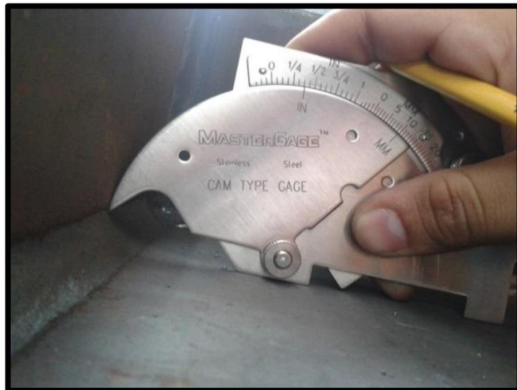
**Foto # 20: Galga para medir espesor de cordones de soldadura en unión patín-arma**
