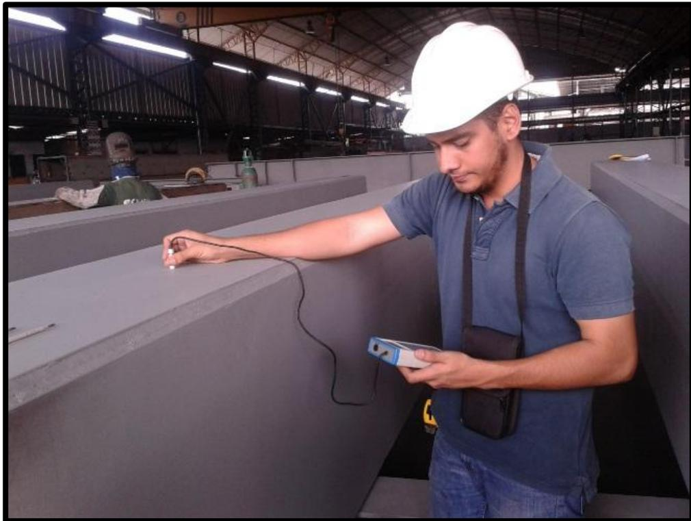
**Foto # 23: Medición de espesores de pintura con micrómetro**
