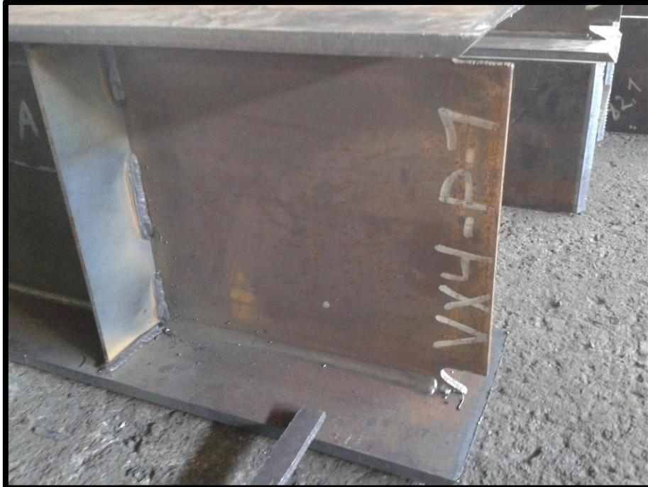
**Foto # 22: Soldadura en vigas**
