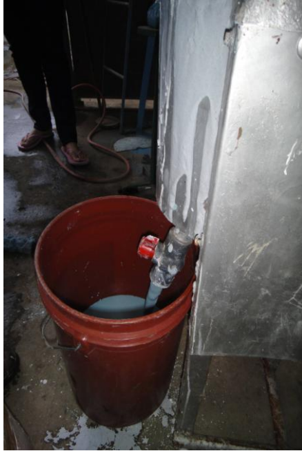
Figura 31.- Elaboración de la Pintura a Base de Hidróxido de Calcio: Pintura Final
