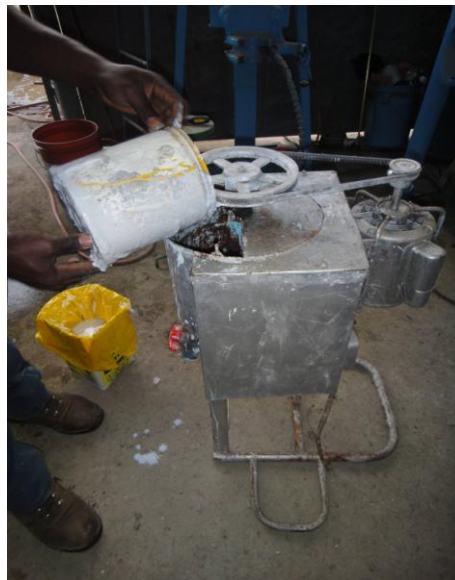
Figura 26.- Elaboración de la Pintura a Base de Hidróxido de Calcio: Incorporación del Hidróxido de Calcio al Mezclador para Materia Prima Fuente: Oxígenos del Guayas S.A.
