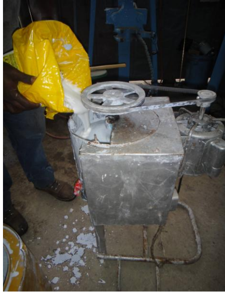
Figura 27.- Elaboración de la Pintura a Base de Hidróxido de Calcio: Incorporación de la Resina Vinílica al Mezclador para Materia Prima Fuente: Oxígenos del Guayas S.A.
