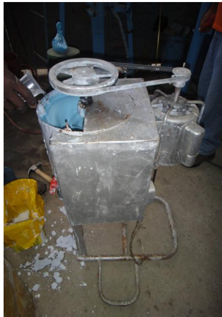
Figura 30.- Elaboración de la Pintura a Base de Hidróxido de Calcio: Incorporación del Formol al Mezclador para Materia Prima Fuente: Oxígenos del Guayas S.A.
