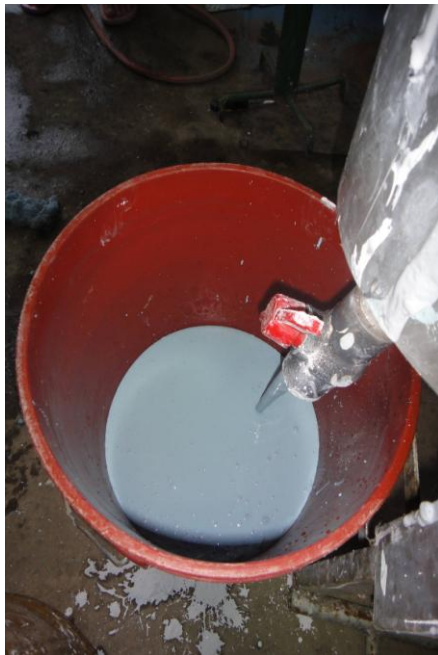
Figura 32.- Elaboración de la Pintura a Base de Hidróxido de Calcio: Pintura Final
