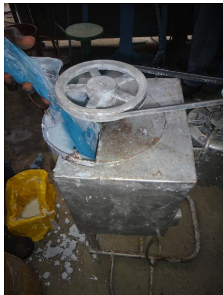
Figura 28.- Elaboración de la Pintura a Base de Hidróxido de Calcio: Incorporación del Pigmento al Mezclador para Materia Prima Fuente: Oxígenos del Guayas S.A.
