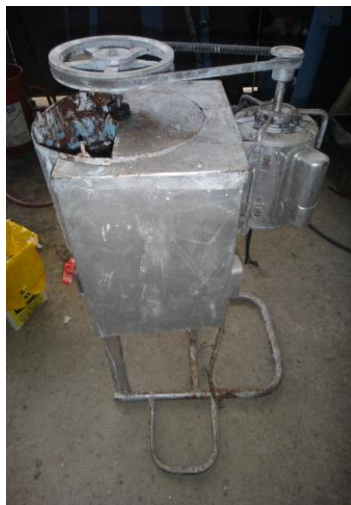
Figura 23.- Mezclador para Materia Prima Fuente: Oxígenos del Guayas S.A.
