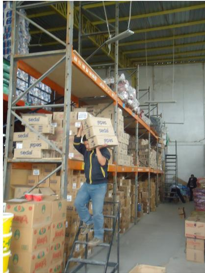
Imagen 5.1 Trabajador en el área de almacenamiento y mantenimiento sin el Equipo de Protección necesario.
