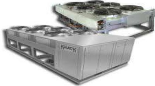
El compresor y el condensador están fuera de la cámara frigorífica mientras que la válvula de expansión y el evaporador dentro de la cámara, generalmente sobre el marco de la puerta de entrada. Al trabajar el compresor eleva la presión del gas que llega caliente de la cámara por las calorías que tomó de los productos almacenados. Cuando el gas llega a los valores de presión y temperatura previstas le corresponde al gas pasar por el condensador a la fase líquida emitiendo calor latente de fusión.
