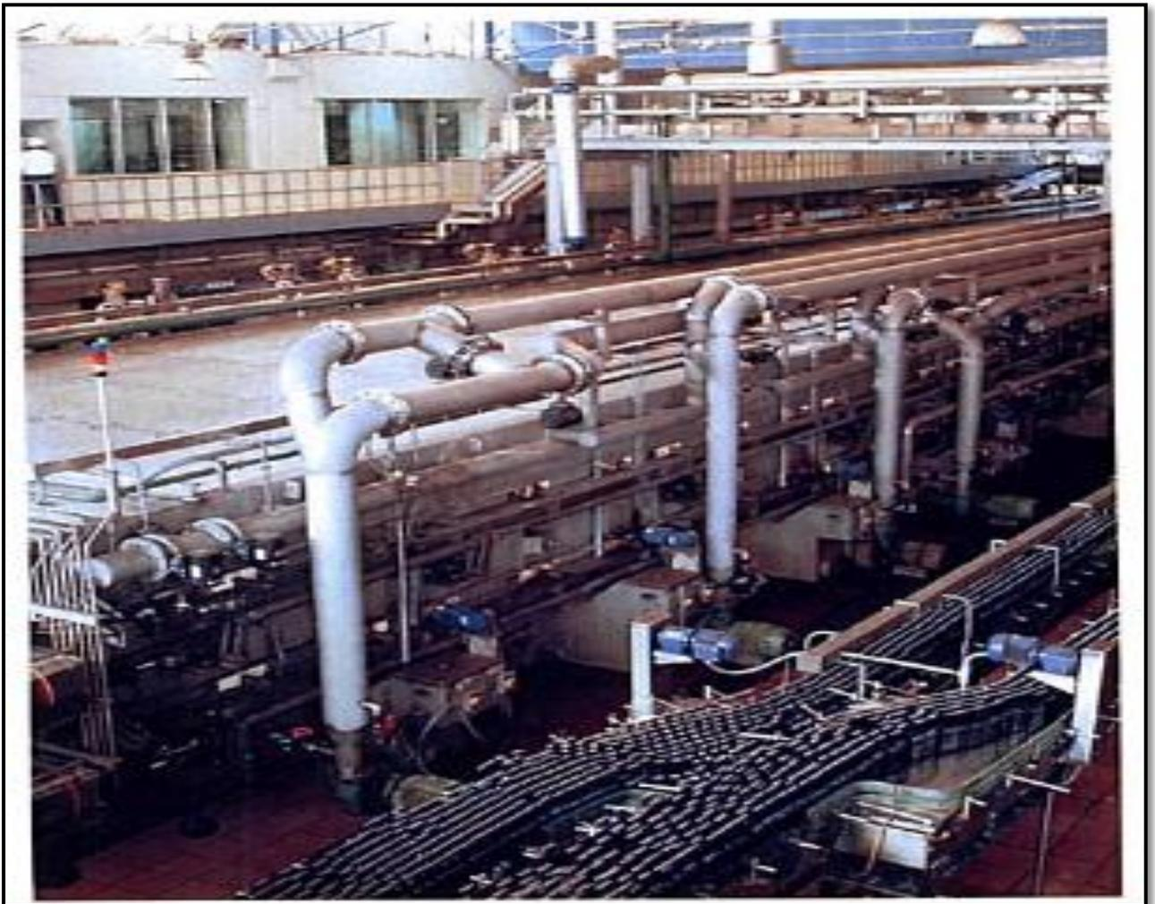
**Fig. 2.6** Pasteurizador túnel de la línea de embotellado
