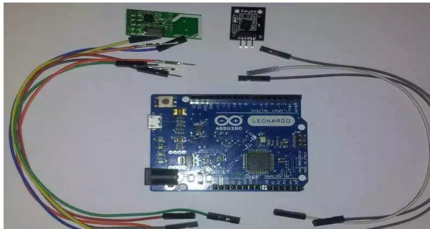
Imagen 08: Prueba de concepto de un módulo de RF conectado a un Arduino. Fuente: zygzax.com
